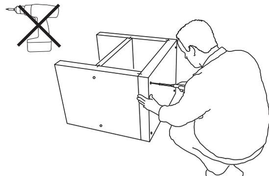
**6)** Visser le plan de toilette. A cet effet, placer les vis dans tous les trous prévus en utilisant les rondelles de calage. Visser les vis avec un tournevis à main jusqu'à ce que la tête de la vis soit à fleur avec la surface.
