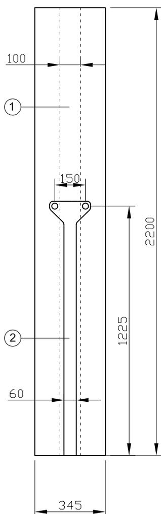
Le panneau JACKOBOARD® est fixé à l'intérieur de la cloison de douche JACKOBOARD® Aqua Circle à l'aide d'un adhésif sur toute la surface avec de la colle à carrelage. Les joints vifs sont ensuite étanchés comme décrit au point 11.
