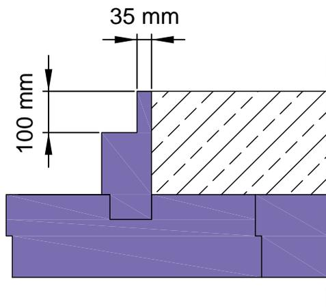
Element de coffrage pour étanchéité (débord de 35 mm d'épaisseur)
