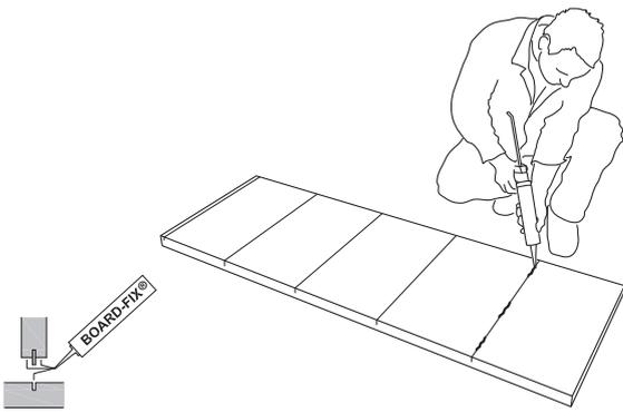
1) Appliquer la colle dans la rainure et sur les côtés de la languette (voir illustration) des deux pièces à assembler (paroi latérale et tablette d'étagère).
