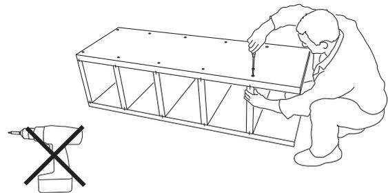
6) Visser les deux parois latérales de l'étagère avec les vis fournies et en utilisant les rondelles de calage dans les trous prévus à cet effet. Visser les vis avec un tournevis à main jusqu'à ce que la tête de la vis soit à fleur avec la surface.
