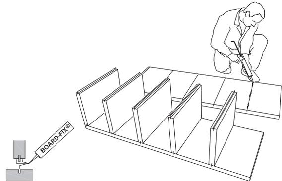
4) Appliquer la colle dans les rainures de la paroi latérale et sur les côtés des languettes (voir illustration) des tablettes.
