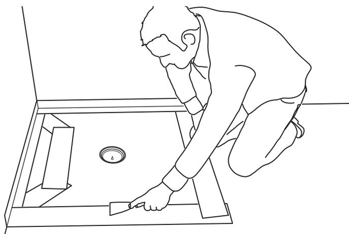
10) Graisser le bord intérieur du siphon avant de poser la cloche anti-odeur. Insérer la cloche anti-odeur (partie inférieure, puis partie supérieure) et bien appuyer.
