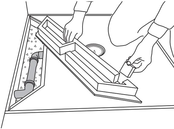
5) Marquer et découper l'orifice à l'aide d'un cutter pour le passage du tuyau sur la surface inférieure de l'élément d'habillage des canalisations (2).
