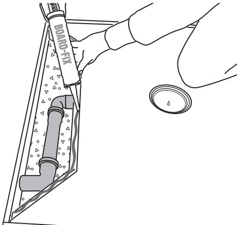
6) Appliquer la colle et mastic d'étanchéité BOARD-FIX® (6) fournie avec le kit par cordon sur la feuillure alternée du receveur de douche. Veiller à ce que la colle soit appliquée de façon continue et sans interruption.
