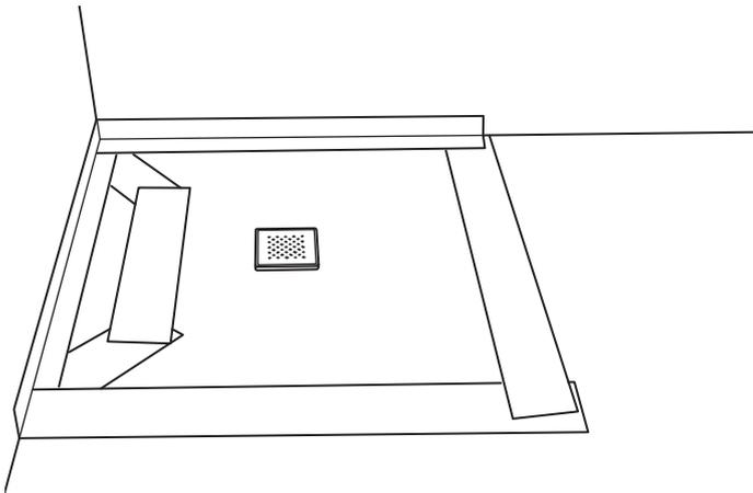
12) Insérer la grille (3). Le receveur de douche peut alors être carrelé à l'aide d'un mortier-colle adapté (colle à carrelage flexible type C2).
