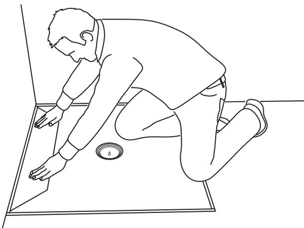
8) Insérer l'élément d'habillage des canalisations (2) dans la réservation puis bien enfoncer. La Colle et mastic d'étanchéité BOARD-FIX® (6) garantit l'étanchéité durable de la liaison.
