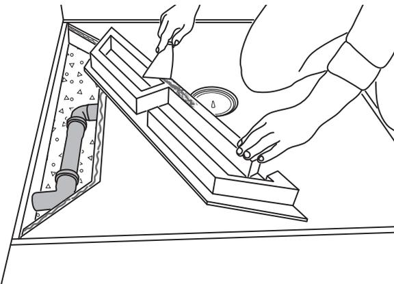
7) Appliquer ensuite le mortier-colle sur la surface inférieure l'élément d'habillage des canalisations.
