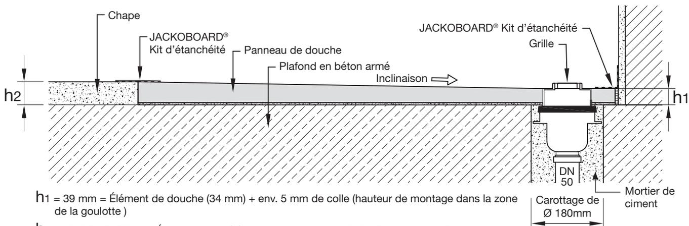
$h_1 = 39 \text{ mm} = \text{Élément de douche (34 mm)} + \text{env. 5 mm de colle (hauteur de montage dans la zone de la goulotte)}$
