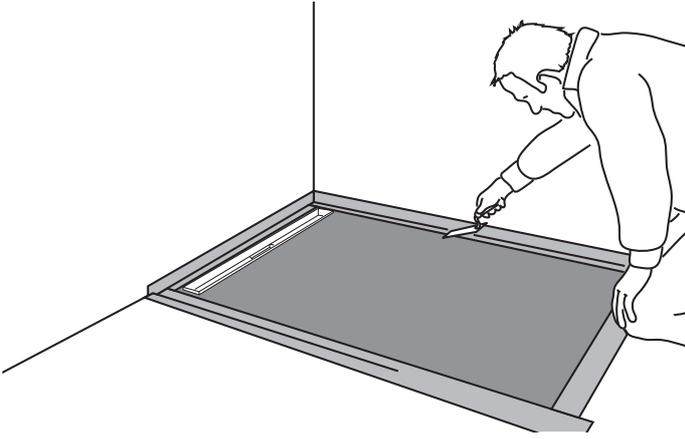
9) Tous les joints de raccordement sont scellés avec le kit d'étanchéité JACKOBOARD® (ou équivalent).
