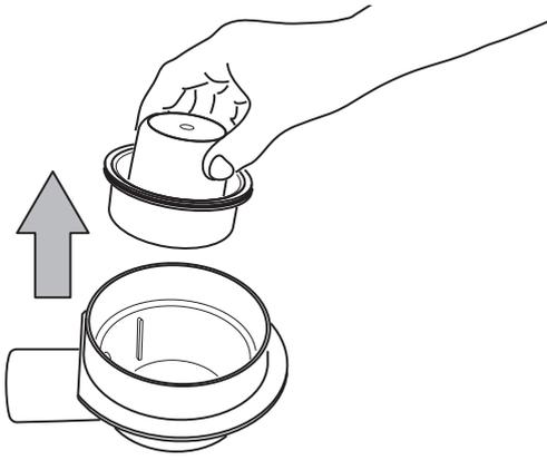
1) Si le siphon de sol est déjà doté d'une fermeture anti-odeur, il doit être entièrement enlevé (haut et bas). Le receveur à écoulement linéaire est déjà équipé d'une fermeture anti-odeur spéciale.
