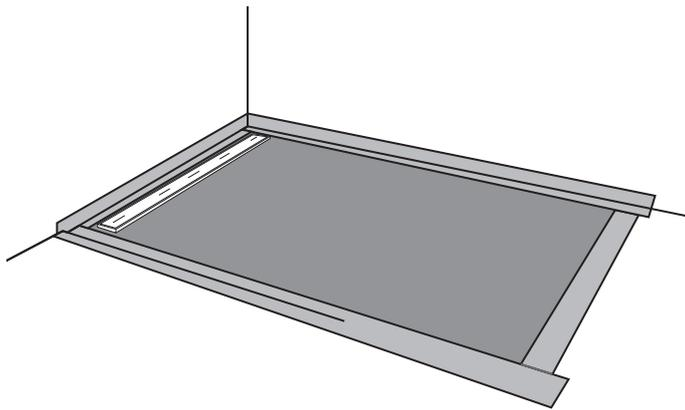
10) Mettre en place la rigole inoxydable. Votre receveur JACKOBOARD® Aqua Line est prêt à être carrelé. La rigole peut être également carrelée. Pour cela, il suffit de la retourner.
