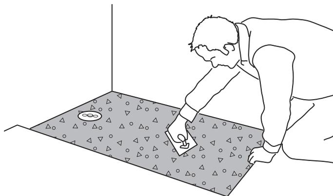
6) Retirer le couvercle de protection. Encoller entièrement la sous-face du receveur avec une colle à carrelage flexible (type C2) en une couche régulière, et une épaisseur suffisante afin de régler le niveau final.
